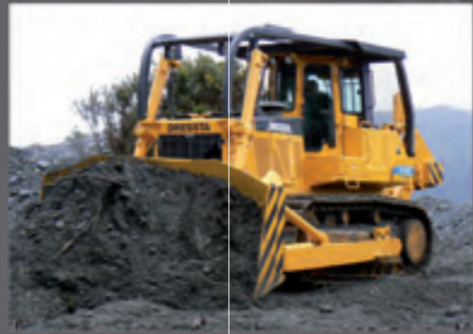
Están disponibles hojas en "U", Semi-U y para Hulla que se adecuan en diversas condiciones operacionales y requisitos de trabajo; Hojas topadoras orientables se destinan a la operaciones de limpieza de superficie que requieren características de planicidad lateral y manejo del suelo.
