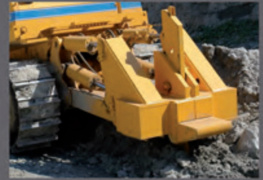
Desgarradores con punta simples o múltiples están equipados con giro hidráulico
