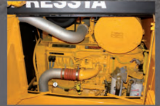
El robusto motor Cummins QSX15 Tier3 con sistema de inyección de altísima presión, controles electrónicos y escape aislado bajo del capó asegura una operación limpia, potente y eficiente con un desempeño sorprendente.
