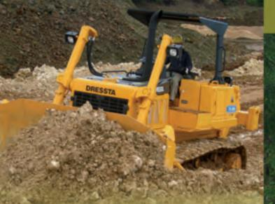
El motor Cummins QSC8.3 atiende las normas de emisiones EPA Tier3 y Euro IIIA. El sistema electrónico avanzado del motor QSC ofrece optimo desempeño con mayor par motor y mejor respuesta del acelerador en todas las rotaciones. Largos intervalos de mantenimiento, mejor arranque en frío y operación más silenciosa, proveen más conforto al operador.
