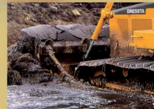
La hoja recta de 3,6 m 3 (4,7 jd 3 ) utilizada con calibre de 2,16 m (85") y zapatas de la cadena de 940 mm (37") (LGP) fue proyectada para áreas blandas y pantanosas. Esta hoja puede ser equipada con cilindros de inclinación hidráulica para realizar eficientes operaciones de embellecimiento de sitios.
