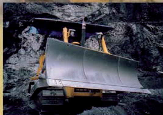
La hoja topadora de 3,8 m 3 (5 jd 3 ) utilizada en las versiones STD y LT es ideal para modelaje lateral, aterramiento, corte de zanjas o acabados de niveles, reduciendo la cantidad de maniobras necesarias para estos trabajos. Hay la opción de inclinación de la hoja con dos cilindros.
