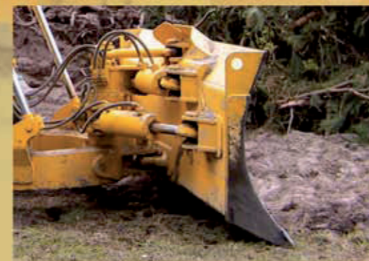
Hoja topadora de 6 direcciones con 3,8 m 3 (5 jd 3 ) utilizada con cadenas largas de 2,03 m (80") de calibre (WT) y largo máximo de las zapatas de 560 mm (22"), siendo mucho versátil en operaciones como acabado de nivel, remoción de material y limpieza liviana de sitios.
