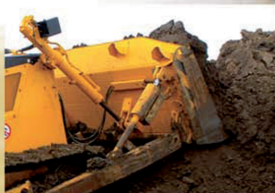
Hoja Semi-U de 5,7 m 3 (7,45 jd 3 ) en las versiones STD y LT, y de 5,95 m 3 (7,8 jd 3 ) en la versión WT, combinando la grande capacidad de penetración de la hoja recta con la mayor capacidad suplida por hojas cortas. Las hojas pueden ser equipadas con inclinación o inclinación/ giro.
